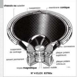
que le principe de la construction n'est pas compliqué. La pièce la plus importante est l'aimant permanent de forme annulaire. Comme tout aimant, il possède un pôle nord et un pôle sud. BRRRRR ... il fait froid tout d'un coup! Enfilez vite la doudoune, les charentaises, le bonnet et les moufles<sup>1</sup>, pour lire la suite.
